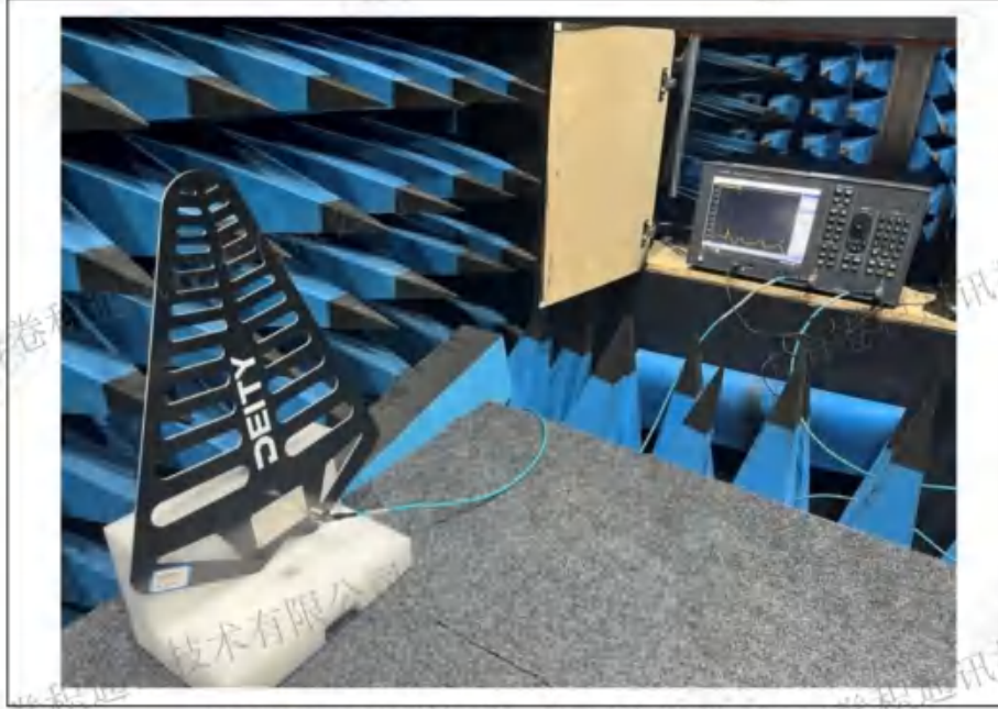
241018001 (FR4板材天线) -电压驻波比测试现场图
